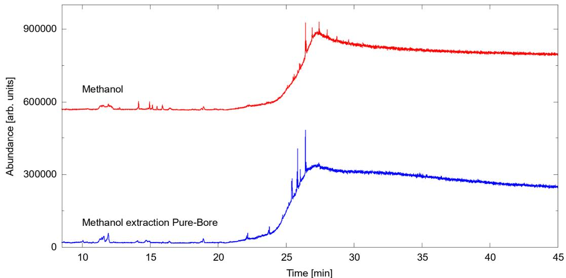
**Abbildung 4:** GC-MS-Chromatogramm des Methanolextraktes der Probe Pure-Bore (blaue Kurve) und von Methanol (rote Kurve, mit Offset dargestellt).
