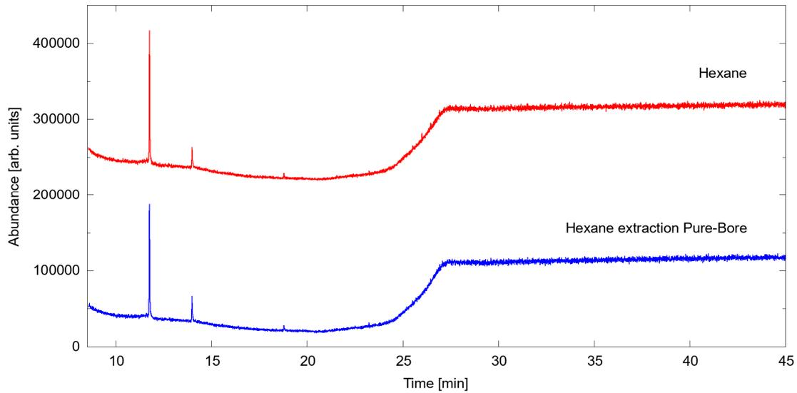
**Abbildung 3:** GC-MS-Chromatogramm des Hexanextraktes der Probe Pure-Bore (blaue Kurve) und von Hexan (rote Kurve, mit Offset dargestellt).
