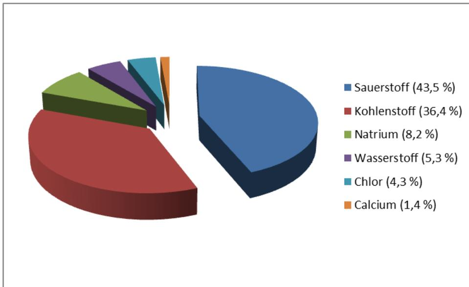
**Abbildung 5:** Zusammensetzung des untersuchten Produktes Pure-Bore.
