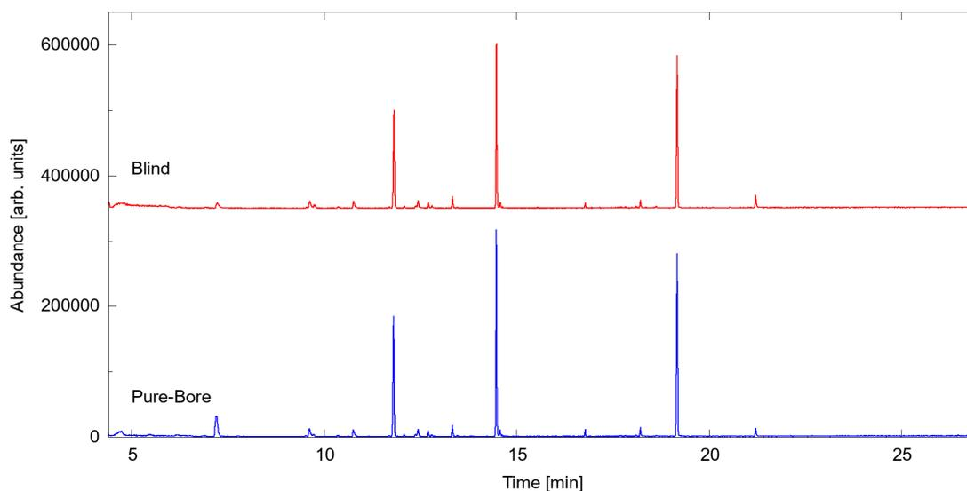
**Abbildung 2:** HS-GC-MS-Chromatogramm der Probe Pure-Bore bei 80 °C (blaue Kurve) und der Blindmessung (rote Kurve, mit Offset dargestellt).
