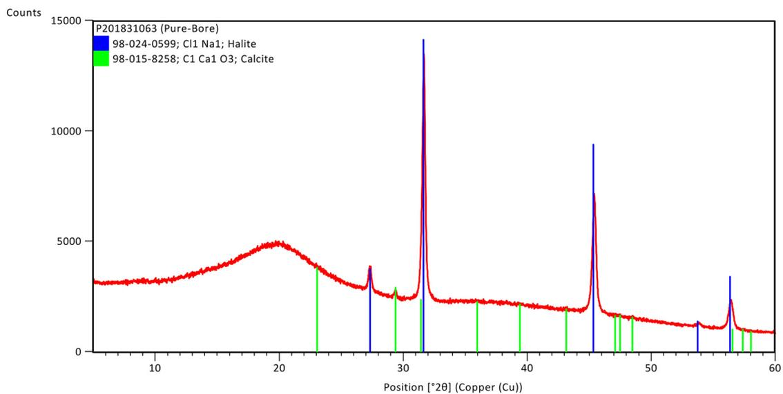
**Abbildung 6:** Röntgendiffraktogramm von Pure-Bore (rote Kurve) mit qualitativer Phasenanalyse (blau: Natriumchlorid, grün: Calciumcarbonat). Die farbigen Linien zeigen die erwarteten Reflexlagen und -höhen für die jeweilige Phase an.
