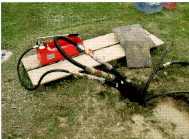
Durch die Steckverschlüsse der Schläuche, Kugelhähne und Manometer ist und bleibt die EWS von Anfang an mit konstantem Druck dicht. Das spart Zeit und unnötige Kosten durch implodierte Sonden.
