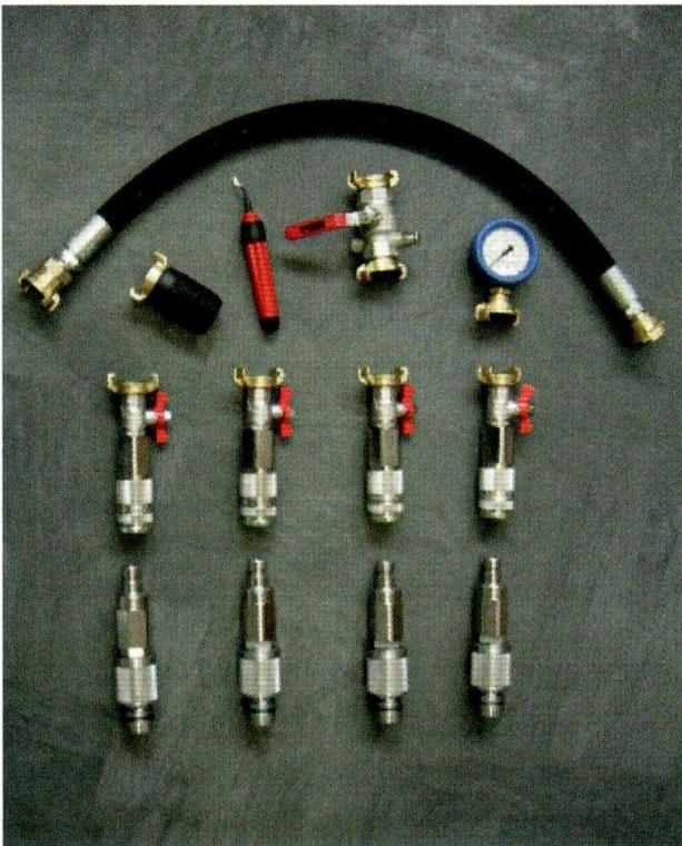
Die Abpress-Garnituren DA32 und DA40 EWS Duplex sind – inklusive Kugelhahn und Manometer – fertig eingedichtet, selbstverschließend und nach der Verpressung bis 20 bar EWS Innen-Druck aufklickbar.
