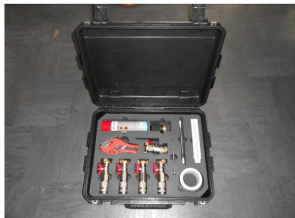
**Schälwerkzeug (PE-Rohr PN20-SDR9) / Vatterteil DA50:**
