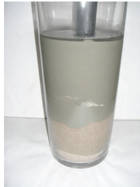
2. Verpressung mit HDG FUSSFIX (helle Stelle = Schnellbinder)
