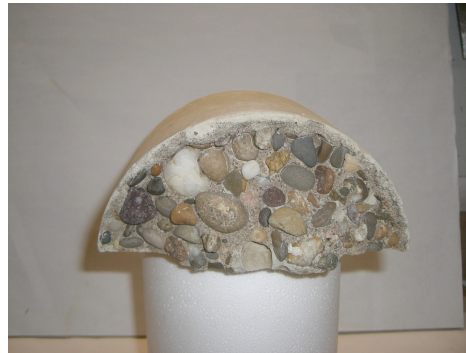
5. Injektion eines Kieskörpers mit HDG FUSSFIX (nach > 1 Stunde)
