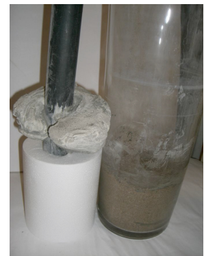
3. Erhärtete Masse am Sondenfuß (nach Ausbau)
