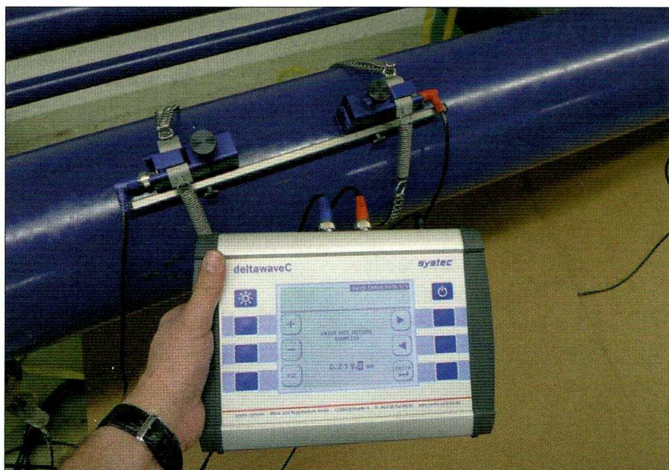
Das Deltawave C-P mit auf Rohrleitung schnell und einfach aufzuschnallenden Ultraschallwandlern
