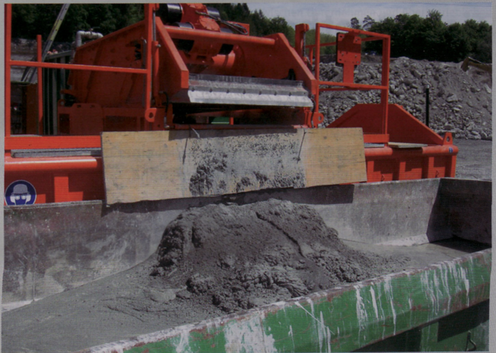
Der Feststoff rutscht über eine Rampe in den bereitgestellten Container. Das reduzierte Gewicht senkt die Entsorgungskosten erheblich. | Foto: HDG
