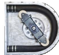
Die wichtigsten Komponenten einer LSM-Schlauchpumpe sind das Pumpengehäuse, der Schlauch und der Rotor. Durch die Drehungen des Rotors drücken die Rollen am Rotor den Schlauch flach. Im Bereich vor der Rolle entsteht ein Überdruck, und durch die Elastizität des Schlauchs entsteht im Bereich hinter der Rolle ein Vakuum. Der Überdruck presst die Flüssigkeit in den Schlauch hinaus und das Vakuum saugt die neue Flüssigkeit an.
