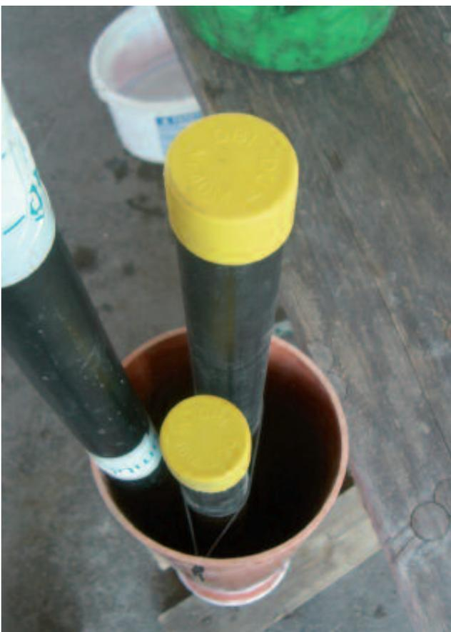
**Abb. 3** Einfach-U-Sonde DA 40 x 3,7 mit Injektionsrohr
