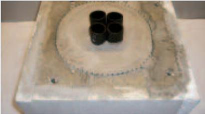
**Abb. 8** Frostbox mit eingebautem Rohrbündel 4 x 32 mm
